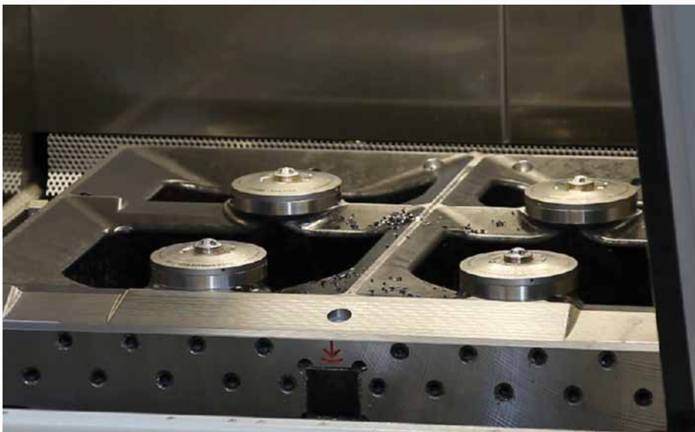
Высококачественный зажимной модуль «Турбина» (арт. № 420919) при применении в полностью автоматизированном технологическом процессе с роботизированной погрузкой.
