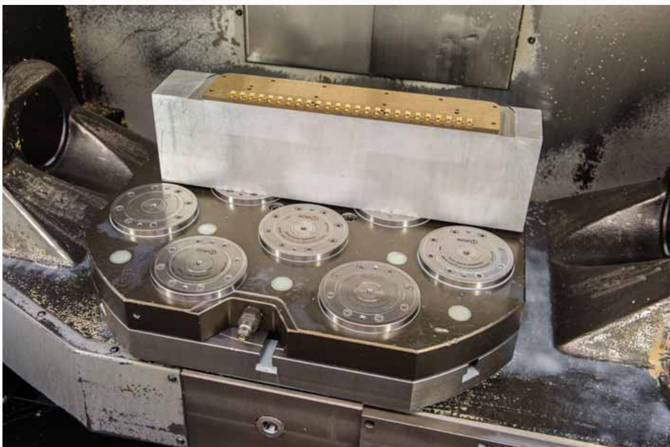
Внутреннее пространство модуля полностью герметично. Таким образом система наилучшим образом защищена от попадания жидкостей и грязи.
