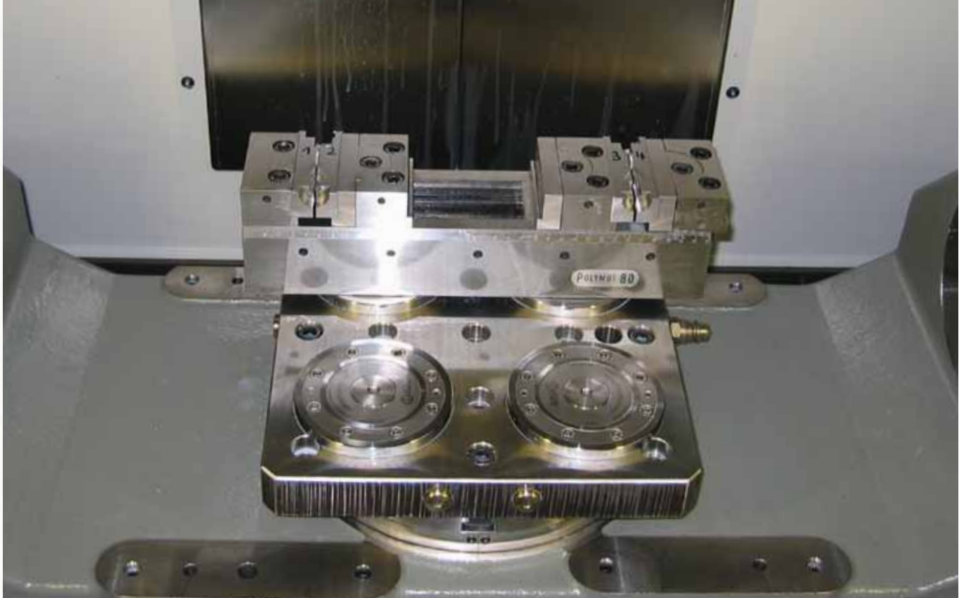
4-х рядный зажимной поддон, смонтированный на круглом столе для быстрой смены устройств
